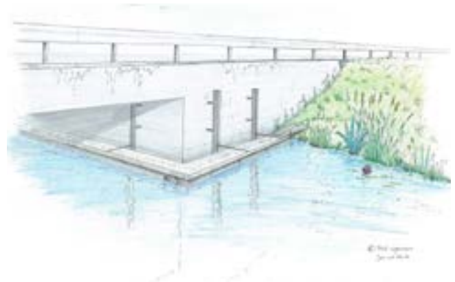
Een loopstrook die met het wisselend waterpeil meebeweegt
