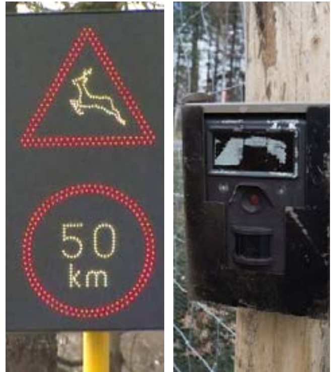
Een sensor die wild detecteert en een elektronisch waarschuwingsbord aanstuurt
