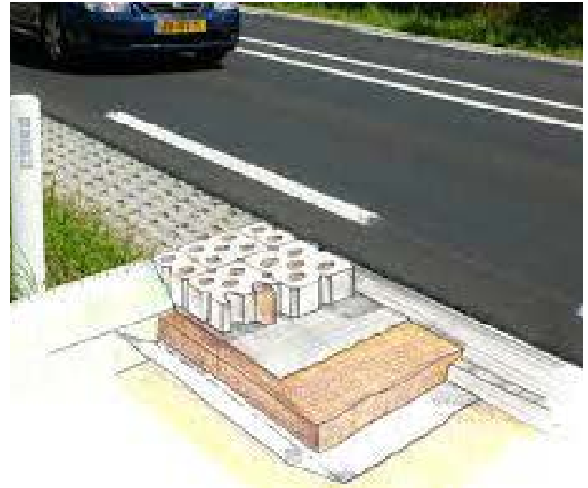
Doorsnede van een zwijnverdwijnblok
