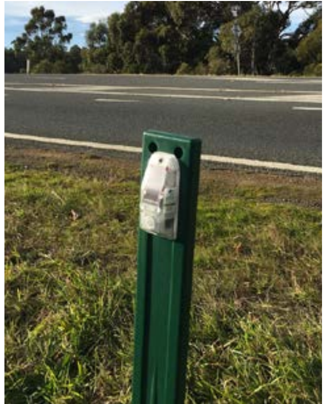
Sensor op paaltje die wordt geactiveerd door koplampen en een licht- of geluidssignaal produceert (Bron: Wildlife Safety Solutions)
