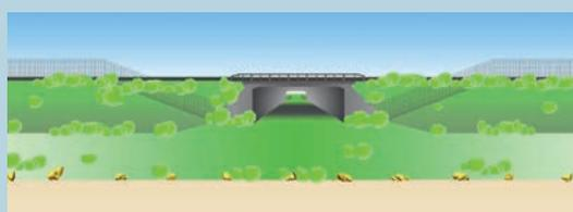
1 Schéma d'implantation des clôtures permettant à la faune d'accéder aux dépendances vertes et d'être guidée jusqu'aux ouvrages de franchissement.
