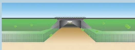
3 Schéma d'implantation des clôtures ne laissant pas les dépendances vertes accessibles à la faune et dont la disposition à l'approche de l'entrée de l'ouvrage crée un effet couloir défavorable au passage de la faune.
