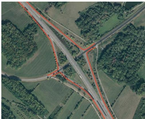
Exemple d'implantation des clôtures au droit d'un échangeur.
