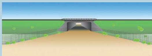
2 Schéma d'implantation des clôtures ne laissant pas les dépendances vertes accessibles à la faune. À l'approche de l'ouvrage, même si les dépendances ne sont pas accessibles, la disposition des clôtures en forme « entonnoir » permet de guider la faune vers l'entrée du passage.
