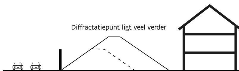
Figuur 3- 12: Vergelijking werking gronddam versus geluidsscherm
