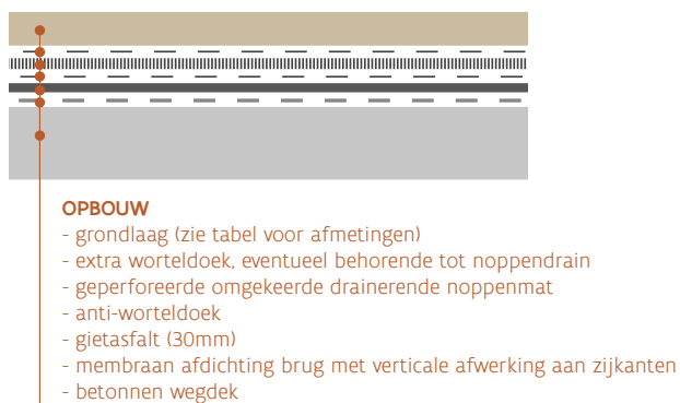
Figuur 8- 5: Voorbeeld van de meest geschikte opbouw van de verschillende lagen op een ecoduct
