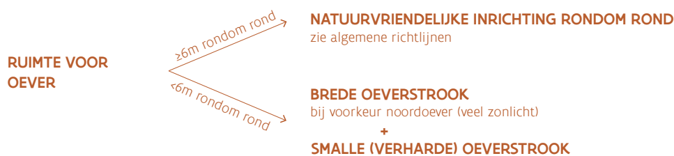
Figuur 2- 18: Beslissingsschema inrichtingsmogelijkheden in functie van de beschikbare ruimte voor de oever
