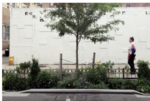
Figuur 2- 4: Bij nieuwe aanleg kan er ook gekeken worden naar infiltratiemogelijkheden in de berm. Op weloverwogen plaatsen kunnen onderbrekingen in de (stoep-)randen het water afvoeren naar de onverharde omgeving in plaats van naar de riolering.
